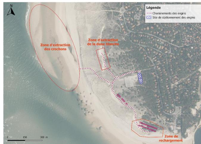
**Figure 6 : Zones de prélèvements et de rechargement des travaux d'urgence de 2018**
